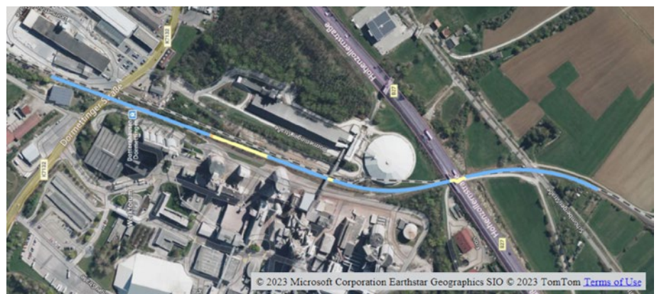
Abb. 6: RTK-Empfangsqualität über die Messstrecke in der Kartenansicht aufgetragen (RTK fix: blau, RTK float: gelb, DGPS: orange)
