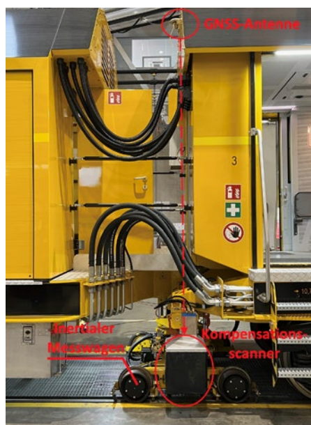
Abb. 8: Multisensor IMU-RTK-GNSS mit Antenne, IMU-Messwagen und Kompensationsscanner
