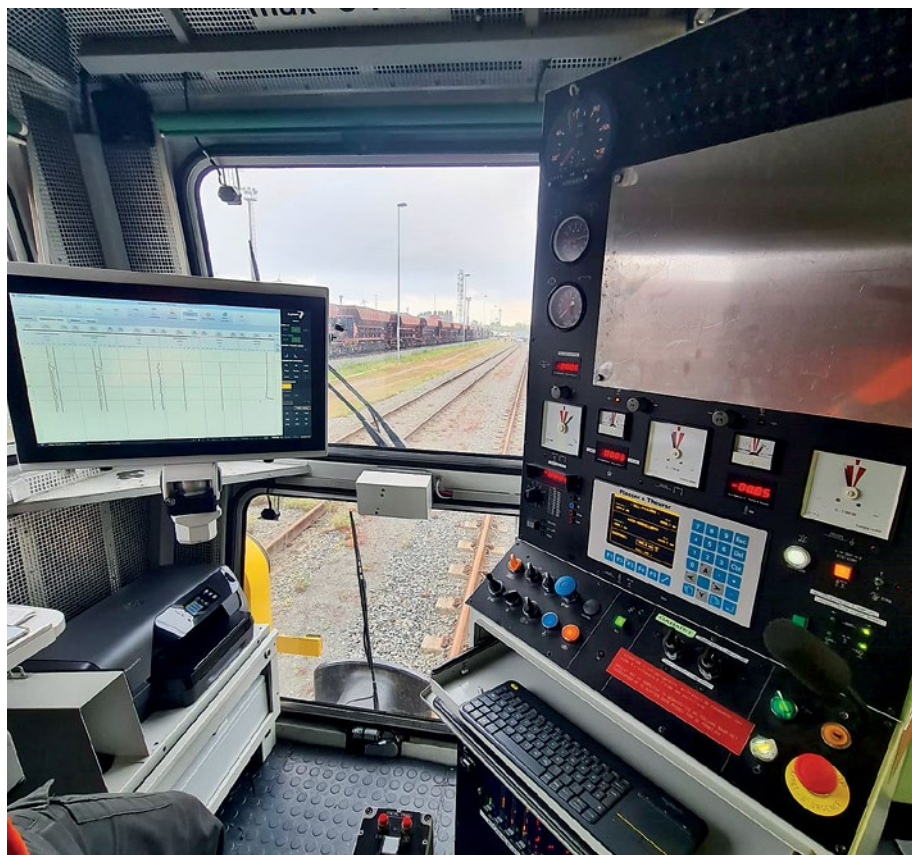
Abb. 2: Aufbau eines Gleislagecomputers CEO++ der Fa. System7 rail GmbH (Touch-Bildschirm links im Bild) auf einer Stopfmaschine des Herstellers Plasser & Theurer Quelle: System7 rail GmbH
