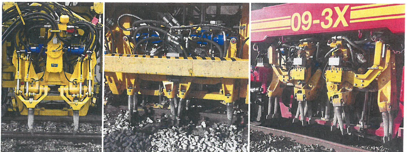
Bild 6: In Originalaggregate von Plasser & Theurer integrierte vollhydraulische Stopfantriebe von System 7 (links: Einschwellenstopfaggregat, Mitte: Zweiswellenaggregat, Rechts: Dreiswellenaggregat)
