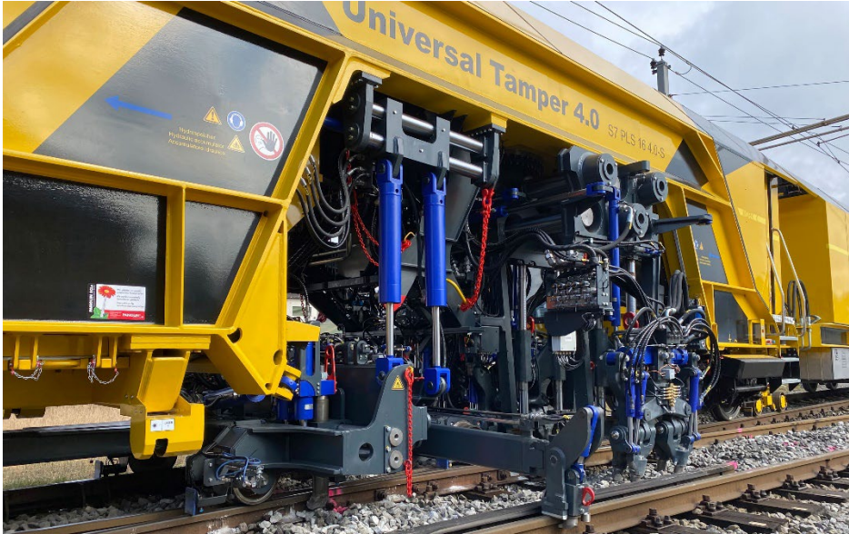
Weichenstopfen mit dem System7 Stopfroboter S7 PLS 16 4.0 - S Foto: System7 Rail Technology GmbH
