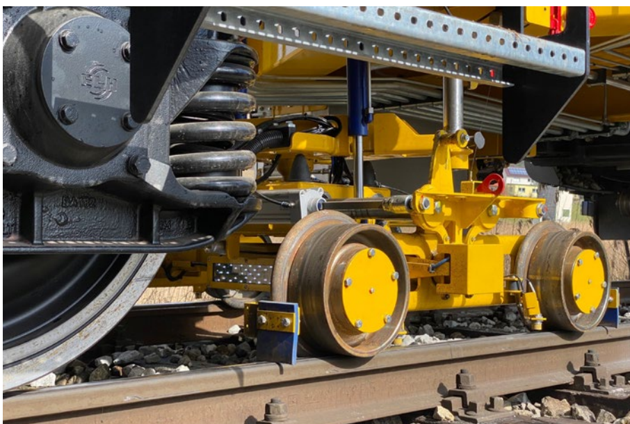
Abb. 6: Inertialer Navigationsmesswagen Quelle: Autor
