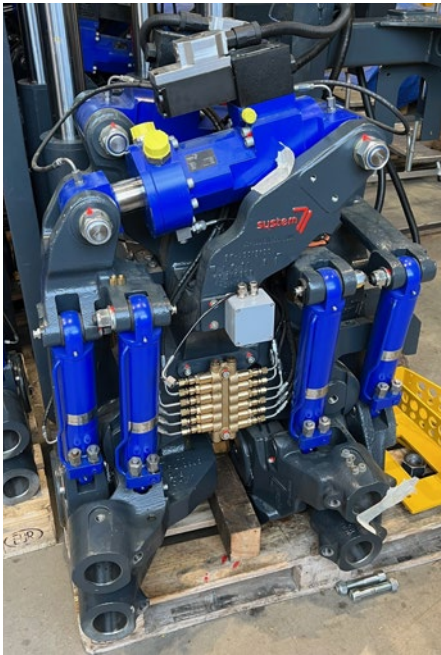
Abb. 2: Split-Head-Stopfaggregat für Zweischwellenstopfung
