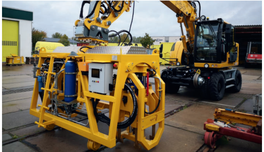
1: Anbaustopfaggregat betriebsbereit mit Bagger
