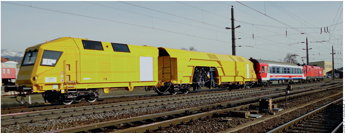
Abb. 4: Zugordnung für die fahrtechnische Prüfung des Nebenfahrzeuges mit Messwagen der ÖBB und Lokomotive
