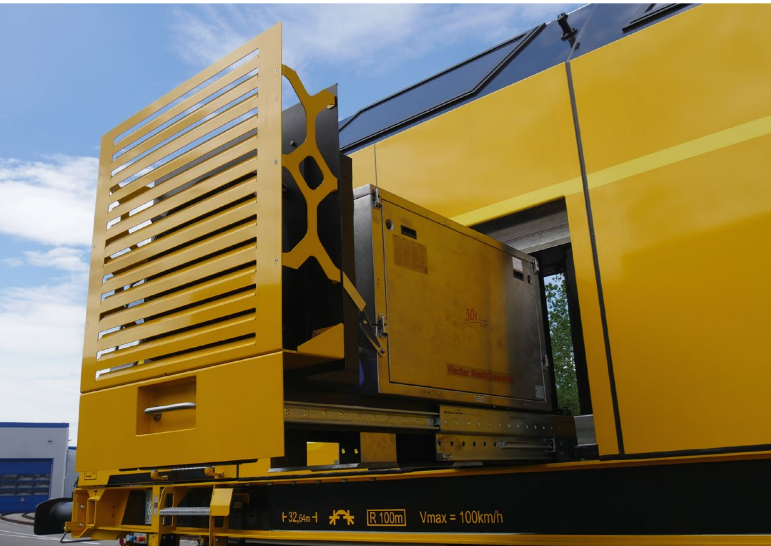
Abb. 7: Zur Wartung herausgezogener Hilfsgenerator
