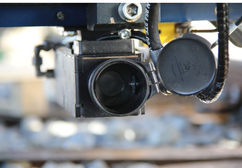
Abb. 5: Kamerasystem (linkes Bild) und LED-Sendemodul (rechtes Bild)
