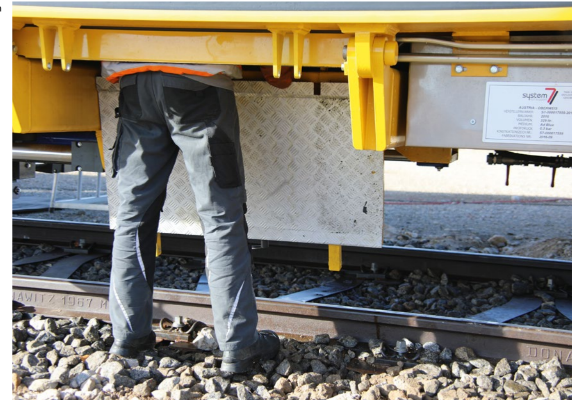
Abb. 6: Wartungsklappen und Wartungsrahmen
