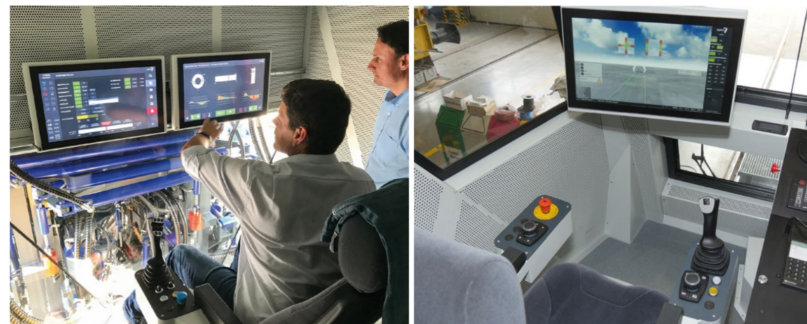
Abb. 8: Links: Stopfarbeitsplatz, Rechts: Gleisgeometrieführungsarbeitsplatz
