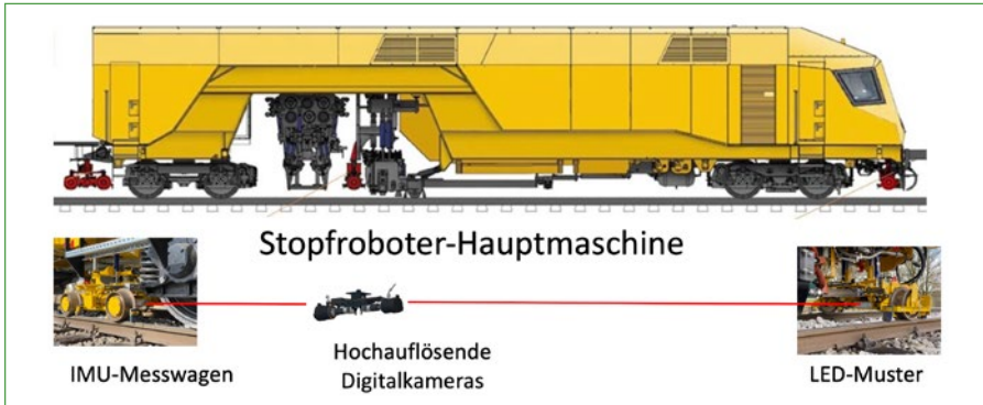
Abb. 7: Optisches Messsystem mit fehlertolerantem selbstüberwachendem Bildauswertungssystem für Höhe, Richtung und Überhöhung
