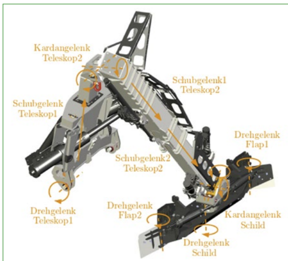
Abb. 11: Kinematik des Flankenpfluges
