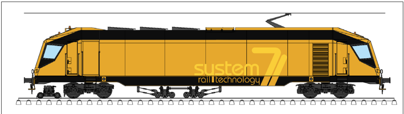
Abb. 7: Modulare Energieversorgungsmaschine mit Zusatzeinrichtungen
